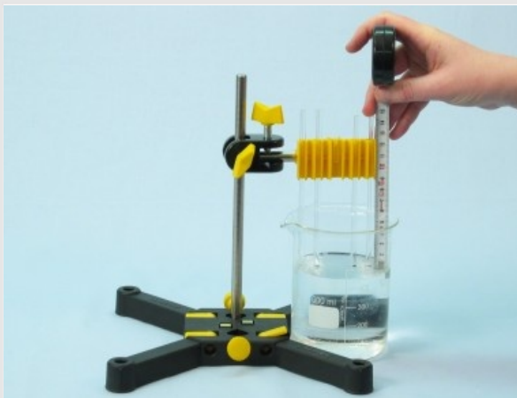
Configuración del experimento para determinar la capilaridad del agua
