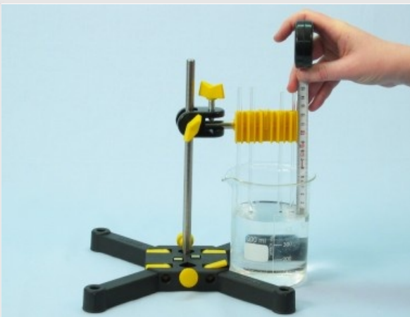
Inmersión de los tubos de vidrio y medición de la altura que se eleva el líquido
