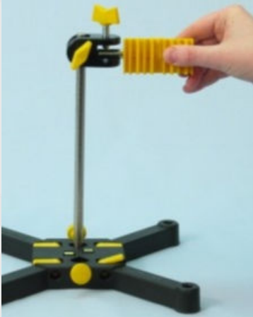
Fijar el soporte del tubo de vidrio a la barra de soporte
