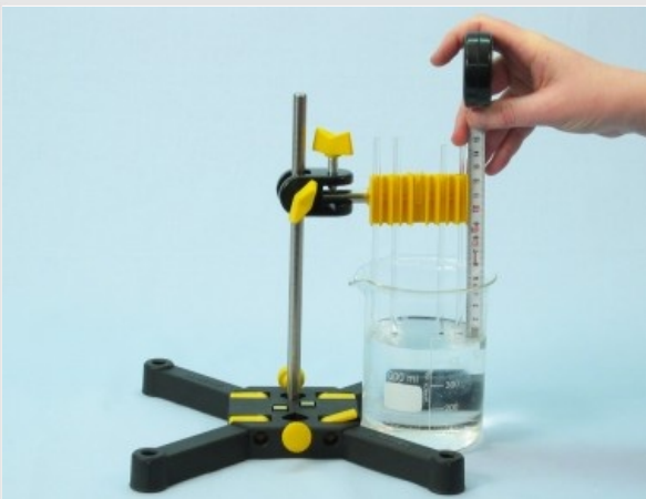
Inmersión de los tubos de vidrio y medición de la altura
