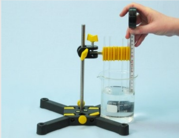
Inmersión de los tubos de vidrio y medición de la altura de elevación
