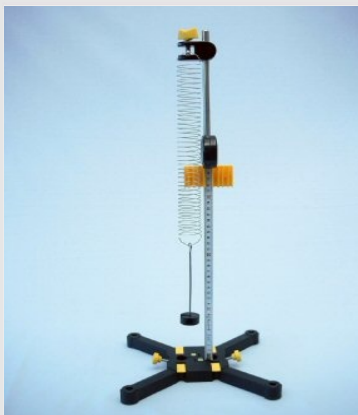
Configuración de prueba para investigar la amortiguación de un sistema oscilante
